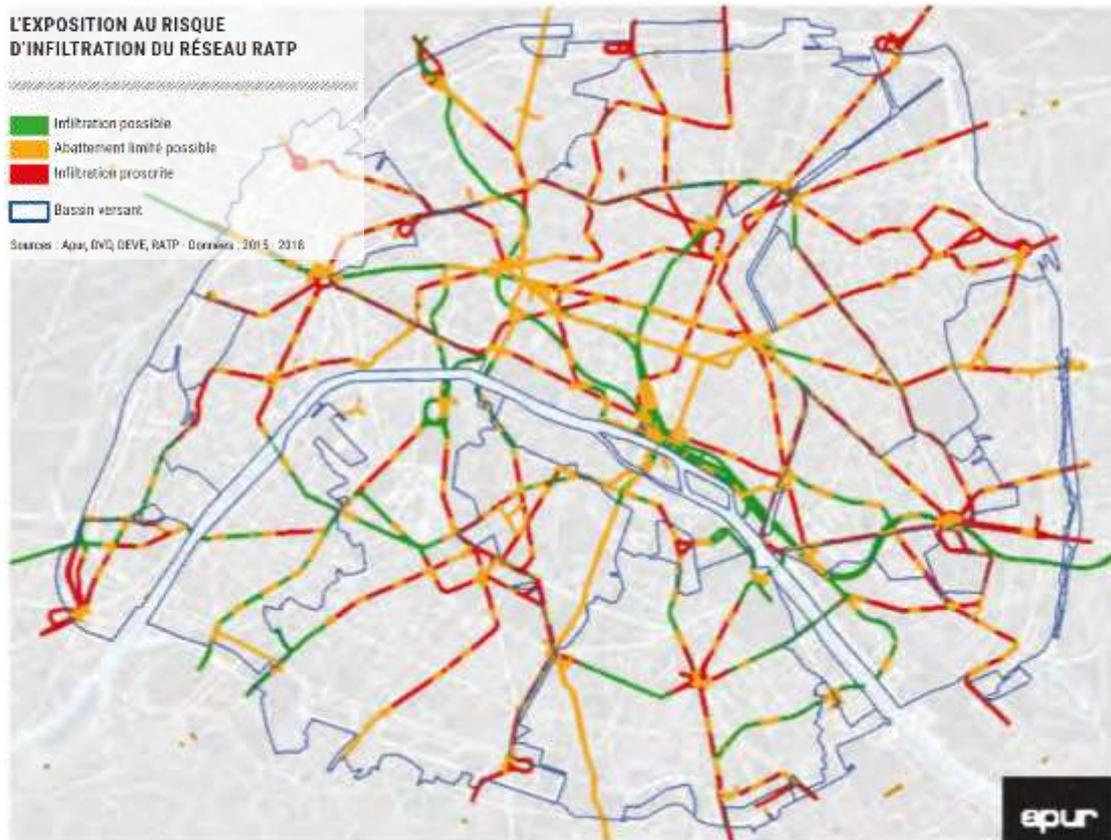
Figure 20. Cartographie APUR : Exposition au risque d'infiltration du réseau RATP
