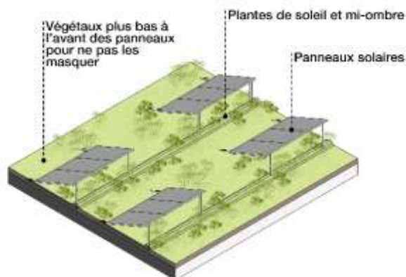
Développer les toitures biosolaires
